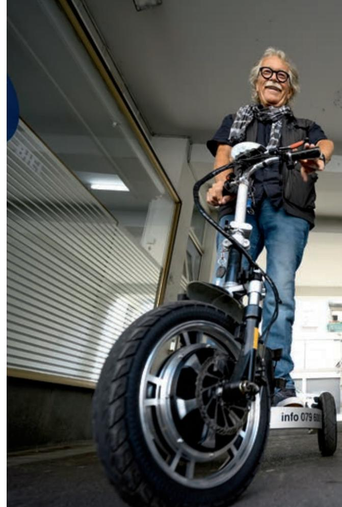
«Eine Person, etwa mit Multipler Sklerose oder Polio, kann mit dem EWO die Strecke gehen, für die sie die Kraft hat. Mit einem einzigen Handgriff kann sie dann die Plattform herunterklappen und stehend mit elektrischer Unterstützung weiterfahren. Oder sie klappt die Satelstütze nach hinten und schon ist ein bequemes und entspannendes Vorwärtskommen im Sitzen garantiert.»
