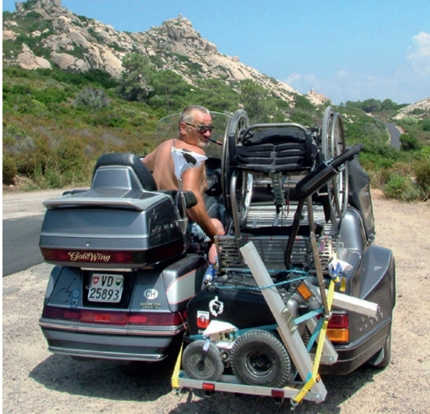
Michel Torny mit seinem angepassten Seitenwagen und dem Swiss-Trac, auf wiederverwendeten Kabelkanälen Michel Torny avec son side-car adapté et le Swiss-Trac, installé sur des rails de récupération (anciens rails à câble électrique)
